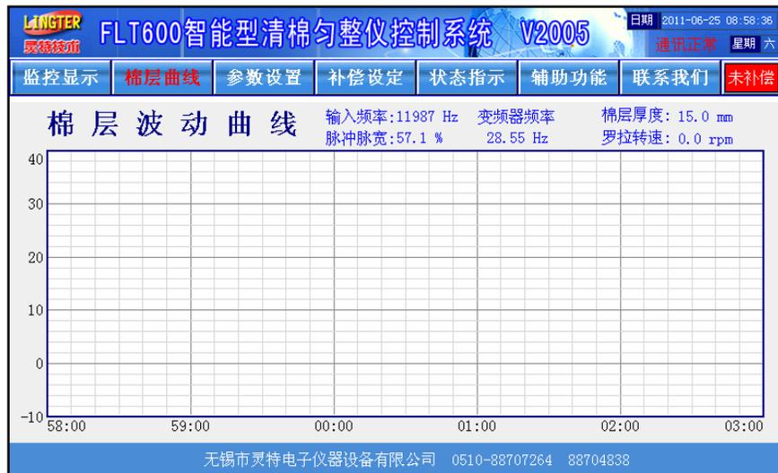
画面中棉层波动曲线将以红色曲线显示，每落一次棉卷，将有一条蓝色竖线将红色曲线分隔。棉层波动曲线真实的反映了天平罗拉处的棉层波动情况，结合棉卷米重波动曲线图，对棉卷的分析、调整带来极大的方便，还可看出供棉情况。
