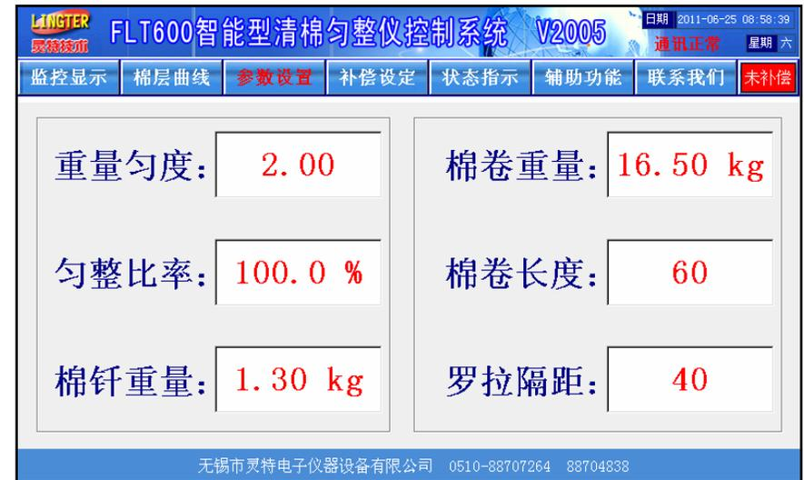
设定参数时点击相应的数据区，将有一个数字键盘跳出，直接输入所要设定的参数，按确认键即可。在数字键盘上方将显示该参数的允许输入的最大值和最小值。如果输入的数据小于最小值或大于最大值，则系统默认为最小值或最大值。
