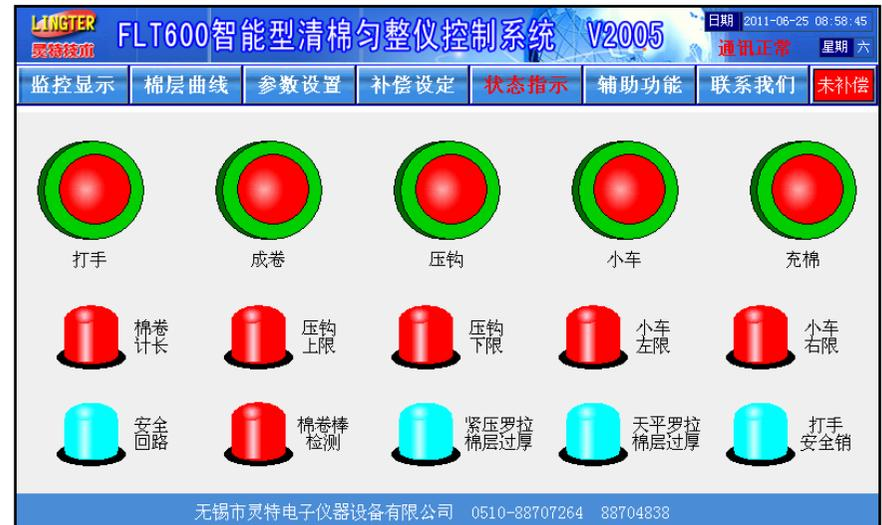
画面显示成卷机的当前工作状态和各行程开关、接近开关的状态，方便机修人员检修设备。
