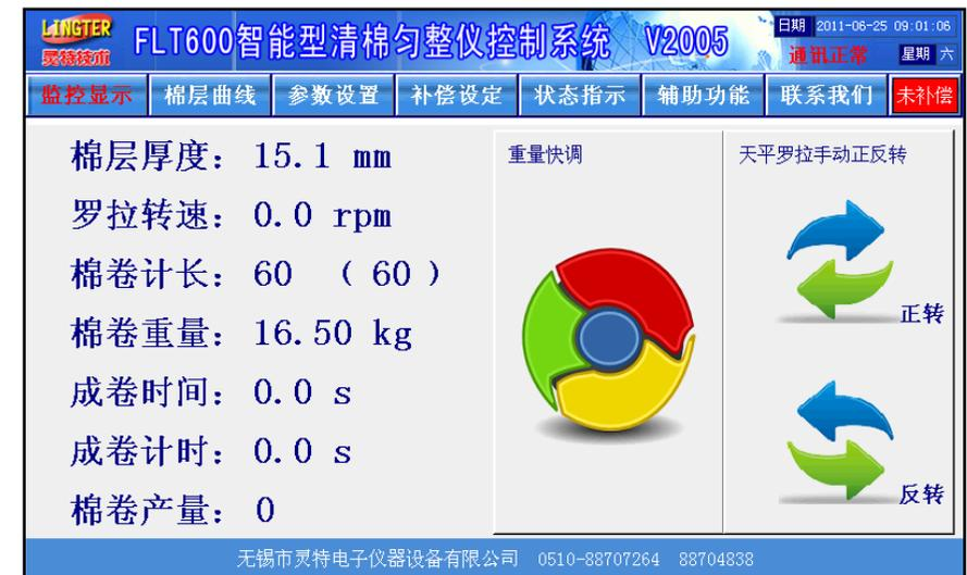
显示画面上方有**监控显示**、**棉层曲线**、**参数设置**、**补偿设定**、**状态指示**、**辅助功能**和**联系我们**共七个标签,用于切换画面,点击相应的标签就显示相应的画面。
