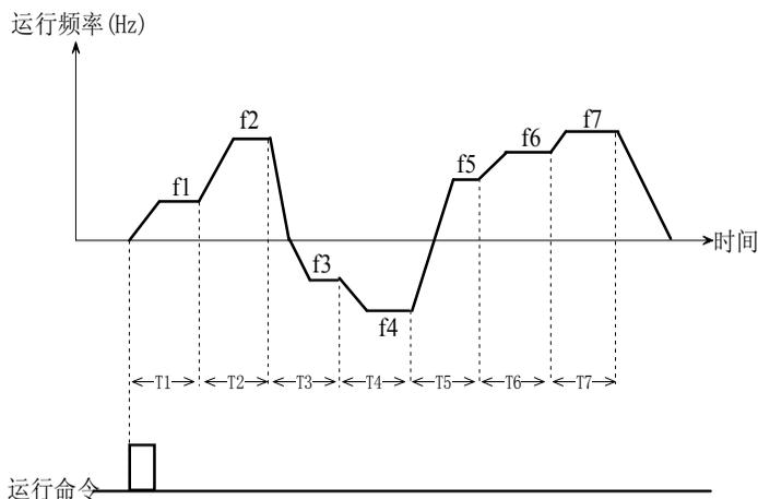
图 5-5-1 PLC 单循环后停机方式
