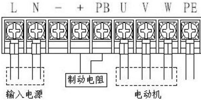
图 2-2 S2R4GB~S22R2GB 机型主回路端子接线
