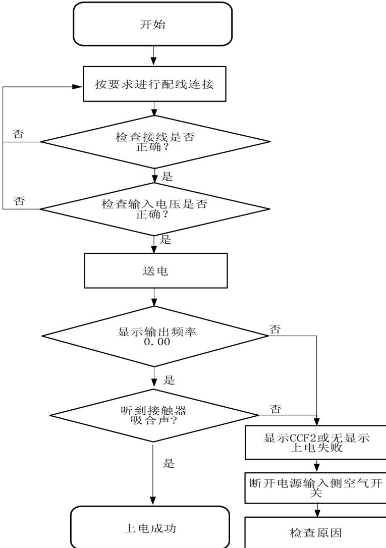
图 3-9 变频器初次上电操作流程
