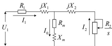
图 5-10-1 异步电机稳态等效电路图
