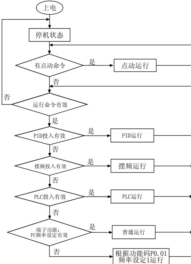
图 3-8 变频器运行状态切换流程
