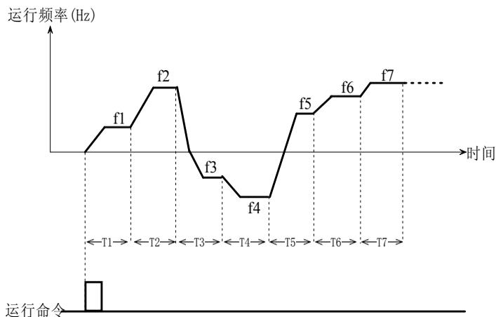
图 5-5-2 PLC 单循环后保持方式
