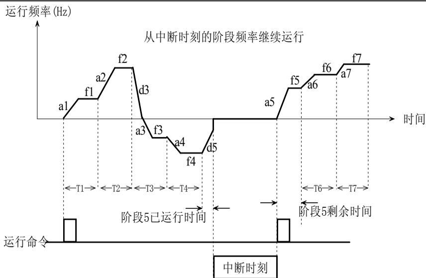
图 5-5-4 PLC 启动方式 1
