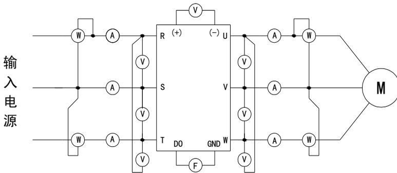
图 8-1 主回路电气测量的推荐接法
