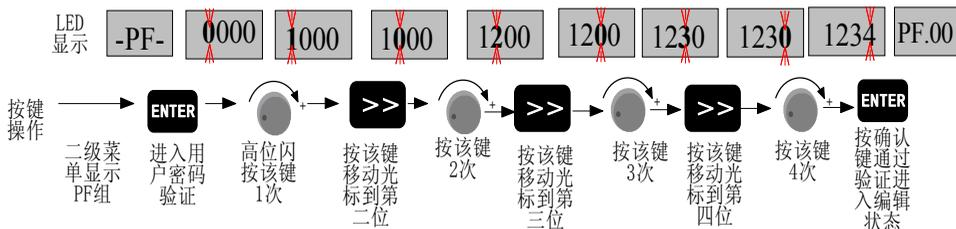
图 5-15-2 用户密码解锁流程
