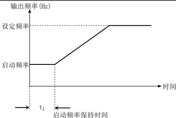
图 5-1-2 启动频率与启动时间示意图
