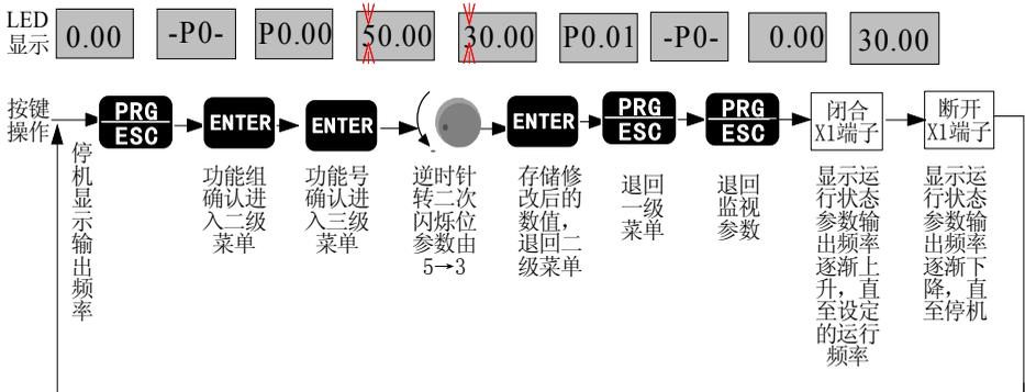
图 3-14 端子运行与停机的操作示例
