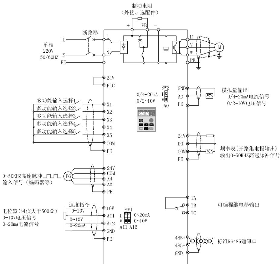
图 2-24 S2R4GB~S2R2GB 接线图
