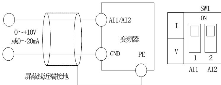
图 2-8 模拟输入端子配线图
