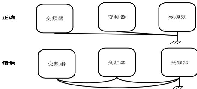
图 2-5 接地线连接方法
