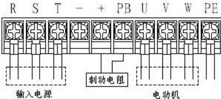
图 2-3 3R75GB/31R5PB~3004GB/35R5PB 机型主回路端子接线
