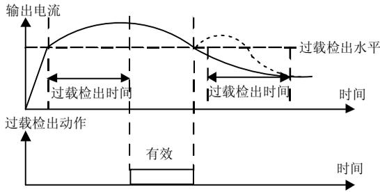
图 5-13-2 过载预报警检出功能示意图
