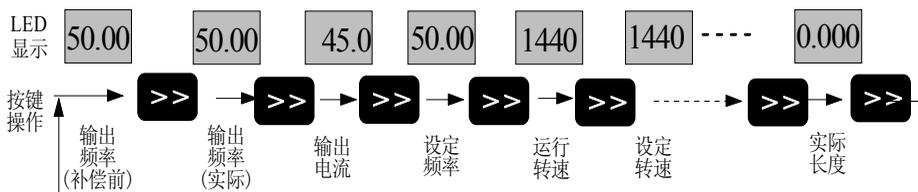
图 3-5 运行状态参数显示操作示例（待机状态切换方法同上）
