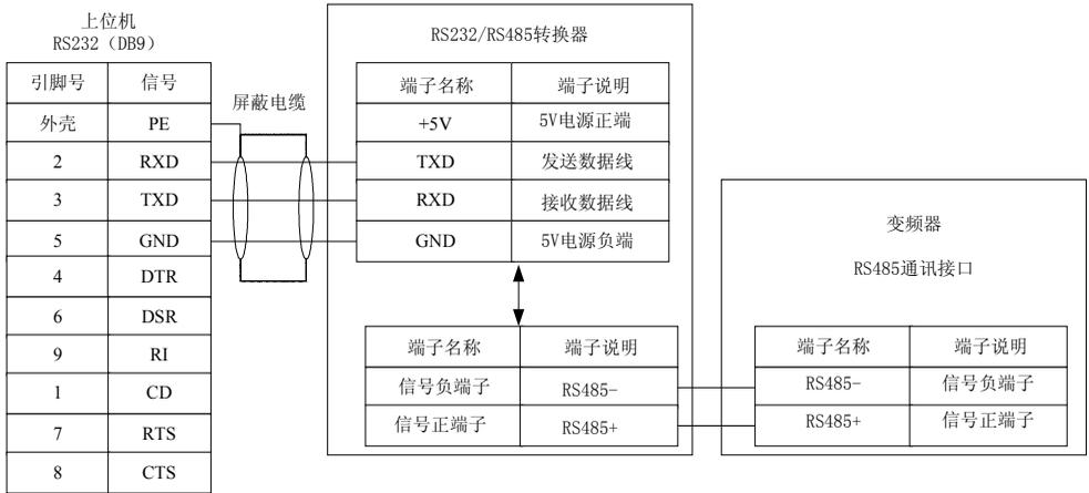
图 2-10 上位机与变频器接口接线图
