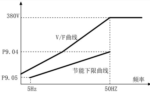
图 5-9-2 节能电压下限限制
