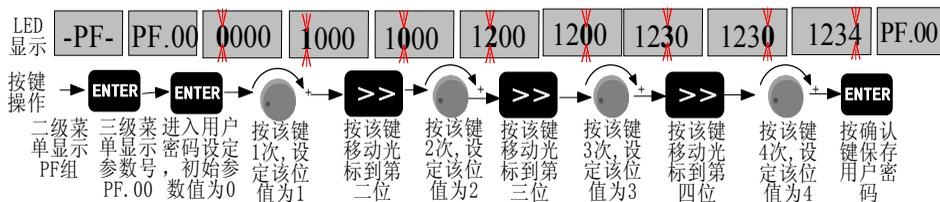
图 5-15-1 用户密码设定流程
