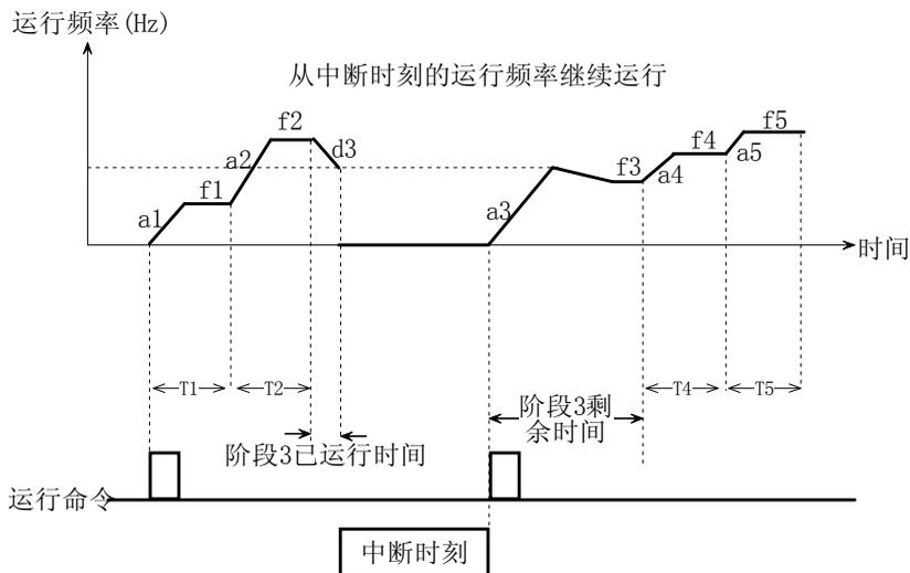
图 5-5-5 PLC 启动方式 2
