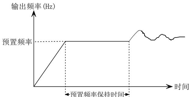
图 5-7-2 PID 预置频率运行示意图
