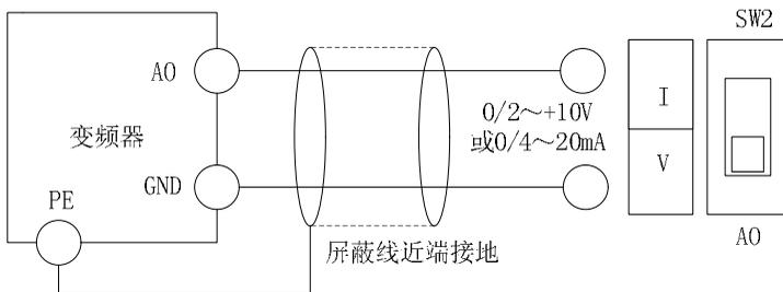
图 2-9 模拟输出端子配线图
