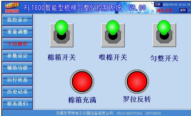
画面中有棉箱开关、喂棉开关和匀整开关三个开关以及棉箱充满和罗拉反转两个按钮。
