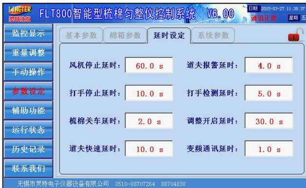
风机停止延时：梳棉机关车后经过设定的风机停止延时时间后停止运转。
