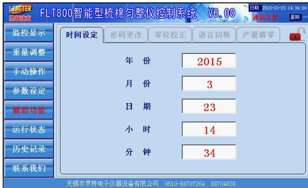
辅助功能画面上有五个页面选项卡标签：时间设定、密码更改、零位校正、语言切换和产量清零，点击选项卡标签，显示画面可以在五个选项卡相互切换，以便操作相应的功能。
