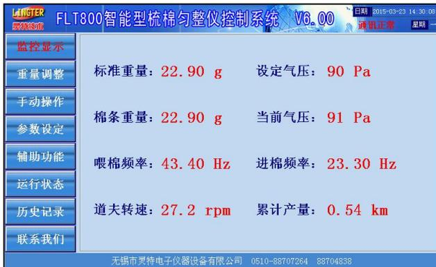
监控画面可显示棉条标准定量、棉条实时重量、喂棉变频器频率、道夫转速、设定棉箱气压、实时棉箱气压、棉箱进棉变频器频率和累计产量。
