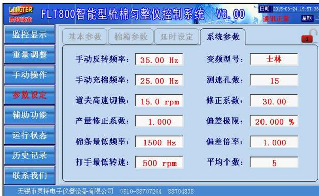
手动反转频率：手动操作喂棉罗拉反转时，喂棉罗拉变频器以此设定的频率进行运转。
