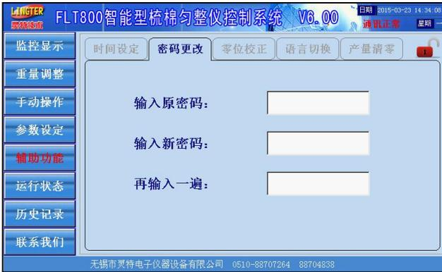
在密码更改选项卡中可以更改触摸屏的系统密码，更改密码后一定切记，否则将无法设定参数，初始密码为 123456。
