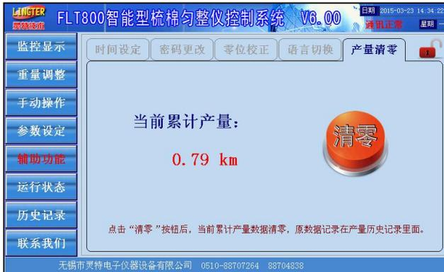
点击清零图标后，当前累计产量数据清零，原产量数据保存在历史记录里面。如果当前累计产量数据为0，则清零图标功能失效，无法进行清零操作。
