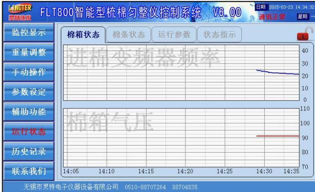
运行状态画面上有四个页面选项卡标签：棉箱状态、棉条状态、运行参数和状态指示。点击选项卡标签，显示画面可以在四个选项卡相互切换，以便观察相应的运行数据。
