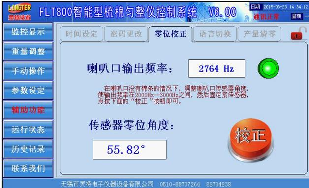
此功能用于喇叭口传感器校正操作。校正前确保喇叭口内没有棉条或其它异物，并且喇叭口加压杆灵活自如，观察显示的喇叭口输出频率。当显示的频率在 2000-3000Hz 之间，并且数字稳定，绿色指示灯亮，可以进行校正操作。如果显示的频率低于 2000Hz 或者高于 3000Hz，红色指示灯亮，禁止进行校正操作，此时应调整喇叭口内传感器的位置，使显示的频率处于 2000-3000Hz 之间，同时固定紧传感器，然后才能点击校正图标。
