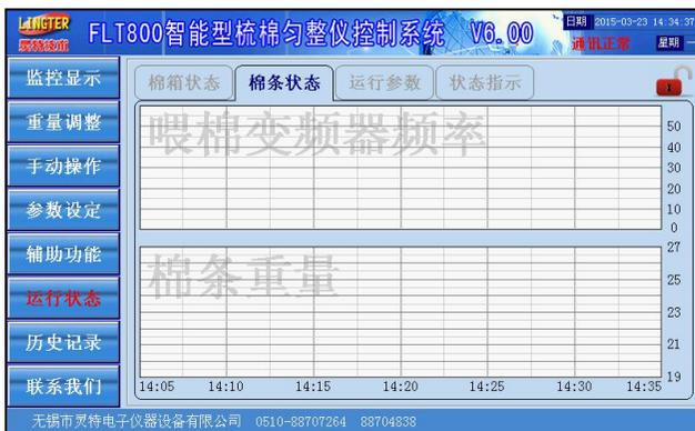
在棉条状态选项卡中可以察看 30 分钟的棉条重量状态，上半部分显示的是喂棉罗拉变频器的输出频率波动曲线，下半部分显示的是棉条重量的波动曲线。
