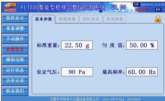
参数设定画面上有四个页面选项卡标签：基本参数、棉箱参数、延时设定和系统参数，点击选项卡标签，显示画面可以在四个选项卡相互切换，以便设定相应的参数。
