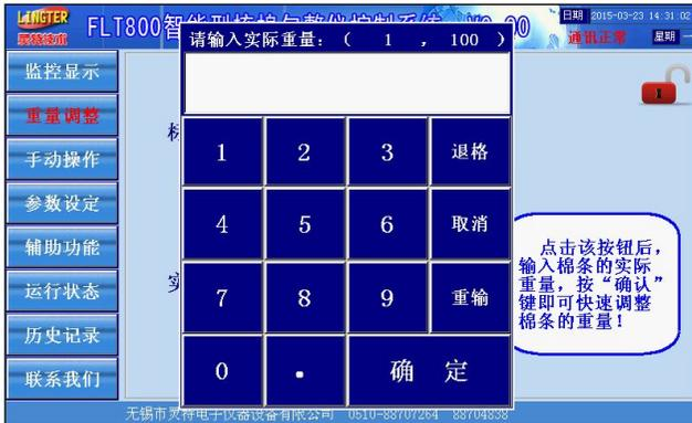
输入棉条的实际重量后按“确定”键，画面恢复到监视画面，梳棉机棉条的重量即输出标准的棉条重量。
