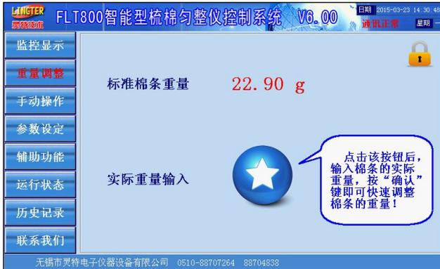
如果梳棉机输出的实际棉条重量与标准棉条重量有偏差，则点击一下“实际重量输入”图标或右上角的
