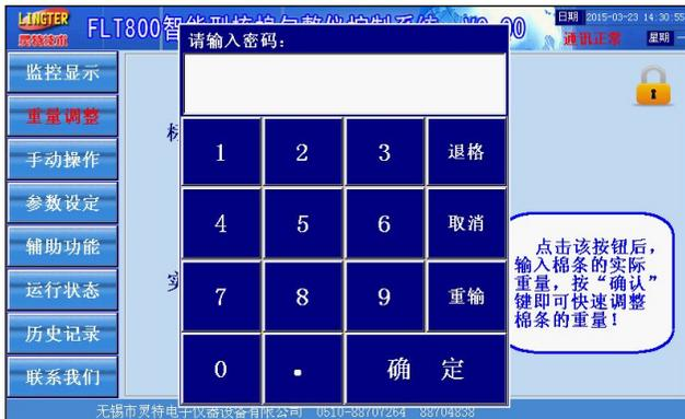
先输入密码（出厂默认值为 123456），点击确定，右上角图标切换为
