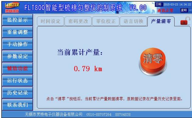
点击清零图标后，当前累计产量数据清零，原产量数据保存在历史记录里面。如果当前累计产量数据位 0，则清零图标功能失效，无法进行清零操作。
